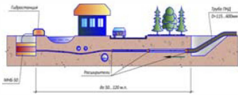
Проколы под дорогами, зданиями, реками МНБ-50 (РБ)
